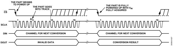
Figure 28. Exiting Power-Down Mode
